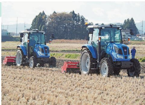
ロボット・トラクタの試験風景（前方のトラクタが無人運転）
