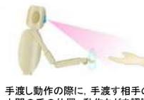
手渡し動作の際に、手渡す相手の人間の手の位置、動作などを認識する。
