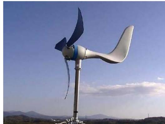
Fig.2 福島大学の7階建ての理工棟の屋上におけるカエデの種型風車
