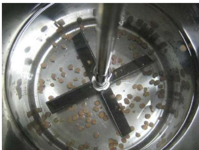
図3 冷媒（シリコンオイル）中で凍結したスラリーの様子
