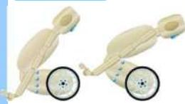
2輪倒立を行うロボットであるので、休止状態(着座)と動作状態(起立)の切り替えが必要。安定かつ高速度な切り替えを実現。
