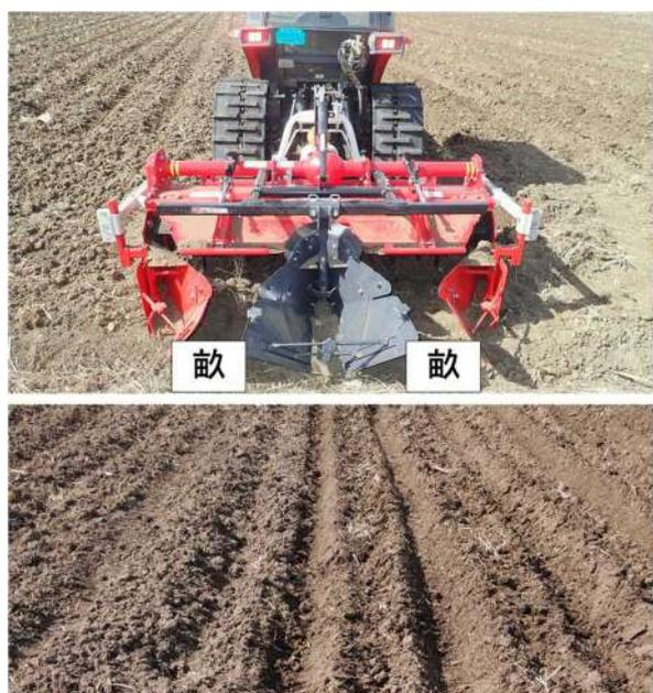
図 1 二山耕起作成機(上)と作成された畝(下)
