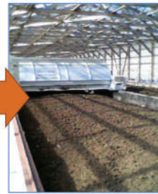
攪拌発酵槽（掻き出すように攪拌する。）
