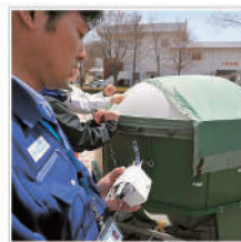
空中の放射性物質を観るラジオゾンデ(手前)を飛ばすため、小型の気球がふく
