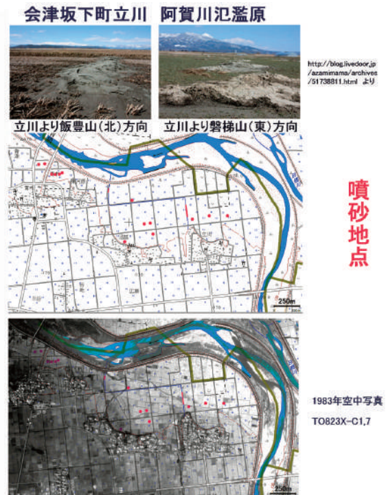
図6-2 会津坂下町立川の阿賀川氾濫原の噴砂
