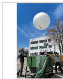
空中の放射性物質を観る装置ラジオゾンデを上昇させるため、気球が放たれた。15日午前11時11分、福島市の福島大、仙波撮影
