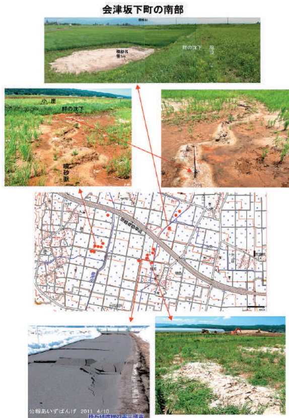
図6-3 会津坂下町南部の扇状地面の造成耕地に生じた噴砂（左下図以外は7月撮影）
